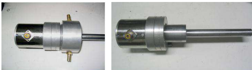
Figura 11.3. Ejemplo de transductores tipo Langevin
