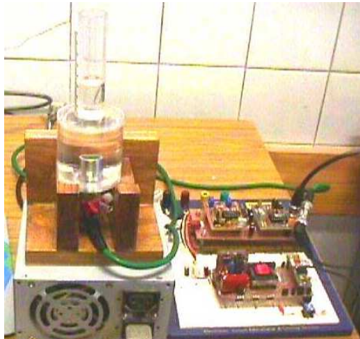
Figura 1.26. Celda para eritrosedimentación y control del ultrasonido (DEA-INAUT-2000)
