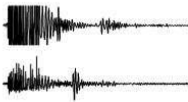
Figura 5.32. Resultado del filtrado adaptable del eco de un envase de conserva alimenticia con defectos en su interior. (INAUT-98)
