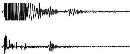
Figura 5.33. Aplicación del algoritmo LMS normalizado al registro de la Fig.5.23 (INAUT-98)
