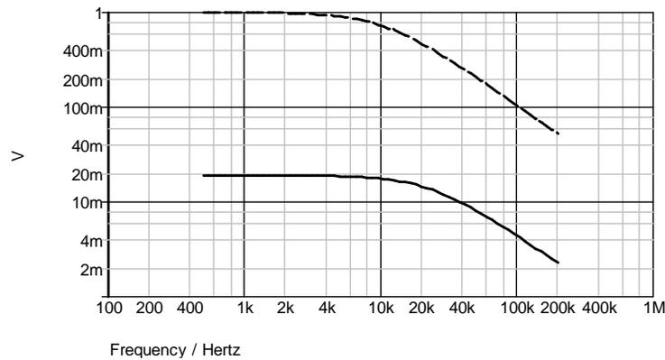
Figura 6.16. Resultado simulación topología serie. Filtro pasa bajos de primer orden, línea a trazos. Filtro con capacitor conmutado, línea continua.
