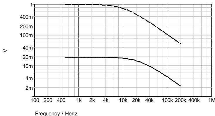
Figura 6.20. Resultado simulación topología Bilinear. Filtro pasa bajos de primer orden, línea a trazos. Filtro con capacitor conmutado, línea continua.
