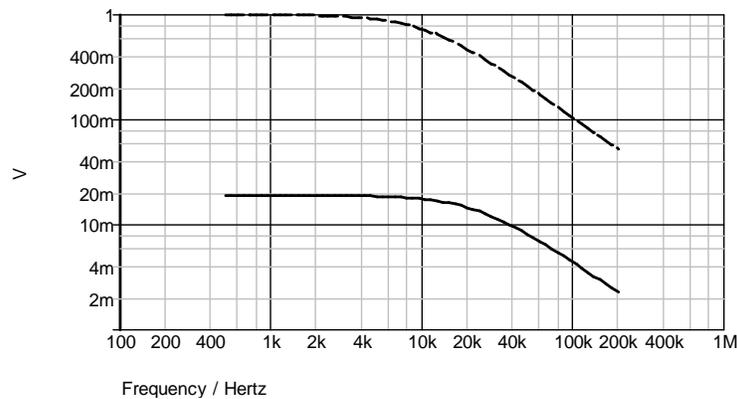
Figura 6.18. Resultado de la simulación topología paralelo-serie. Filtro pasa bajos de primer orden, línea a trazos. Filtro con capacitor conmutado, línea continua.
