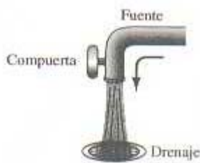
Figura 5.3 Analogía hidráulica para el mecanismo de control del JFET.
