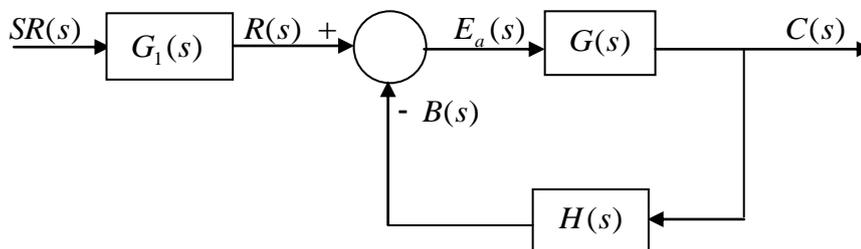
Figura 5. Sistema SISO con realimentación no unitaria
