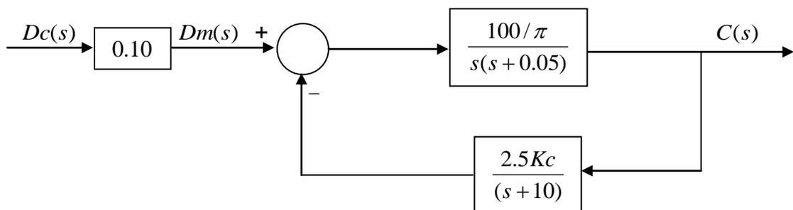
Figura 4. Diagrama en bloques del control de posición modificado. Donde la perturbación  $Dc(s)$  es un escalón de 1Nm.-
