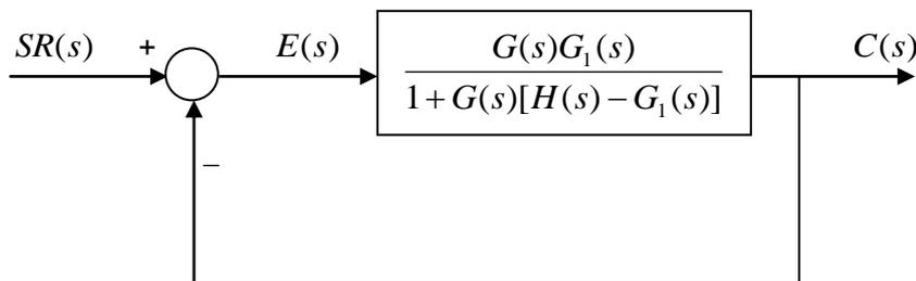
Figura 7. Diagrama en bloques reducido de realimentación unitaria.
