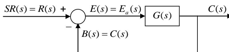
Fig. 2. Diagrama en bloques para un sistema de realimentaci\acute{o}n unitaria.
