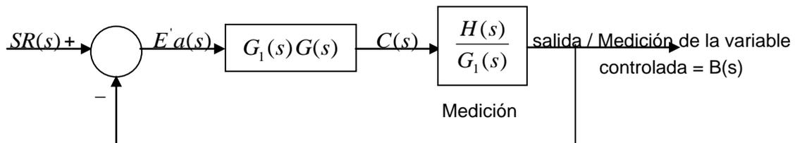
Fig. 9. Sistema equivalente de realimentación unitaria mostrando  $E'_a(s)$ .
