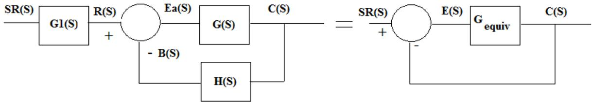
Figura 6. Equivalencia entre los diagramas de bloque con realimentación  $H(S)$  y con realimentación unitaria.
